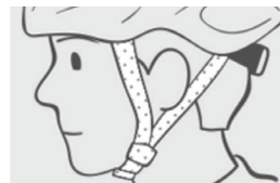
悪い例: 2 アジャストロックが適切な位置でない
